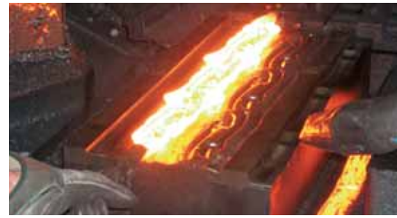
Einsatz von Werkzeugstahl in der Gesenkschmiede.
